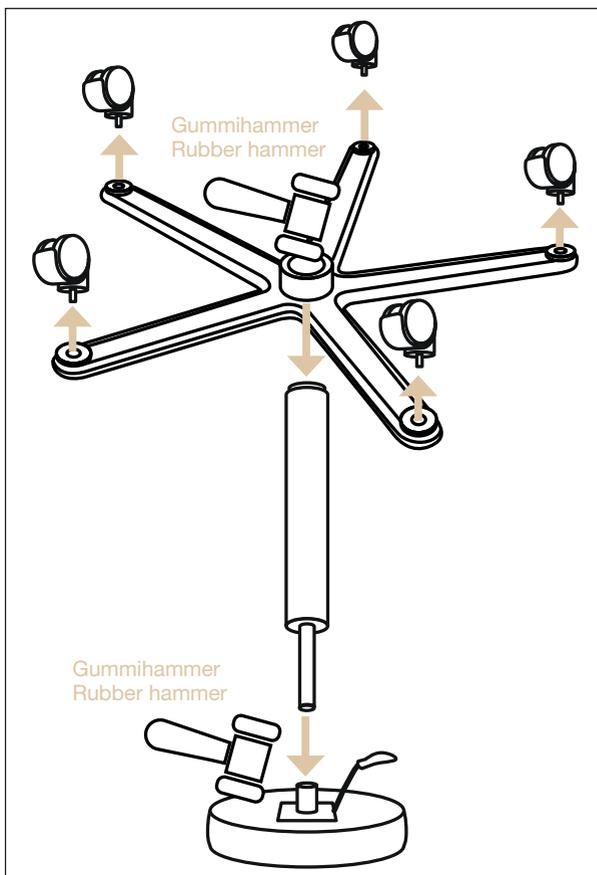
**!** Info: Die Montage eines Rollhockers erfolgt werkzeuglos. Dabei presst sich die Gasfeder durch die konische Form unten in das Fußkreuz sowie oben in die Sitzplatte.
